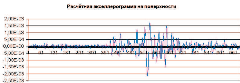
Рис. 3. Зависимость ускорения от времени t \cdot 0.02 с.
