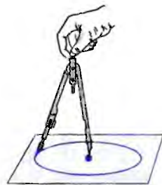
Построение окружности с помощью циркуля
