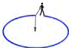
Построение окружности с помощью веревки
